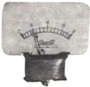
Fig. 7 - Sistema per rendere idonei strumenti a ferro mobile per impieghi elettronici.
