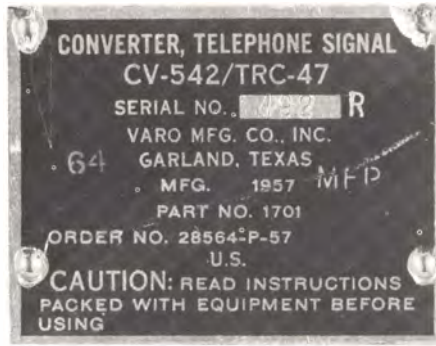
Fig. 6 - Targhetta di un apparecchio piuttosto vecchio essendo stato costruito negli USA per conto dell'aeronautica britannica. Si tratta di una attrezzatura aeroportuale che rende intelleggibili i segnali ricevuti tramite una linea telefonica, prima di essere trasmessi, via radio. Un "encoder" quindi, impiegato con l'opportuno "decoder" sull'aereo. La piastrina è "bistandard", riporta il codice inglese (CV-542) e quello U.S.A. (TRC-47).
